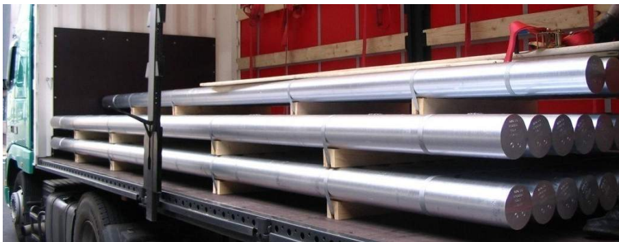
Nakládka čapov dĺžky 6 m – 2 sekcie – prvá blokováná dopredu čelom návesu
