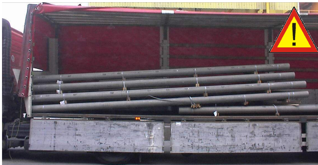
Posun 7 metrových čapov pri brzdení a prerazenie čelnej steny návěsu
