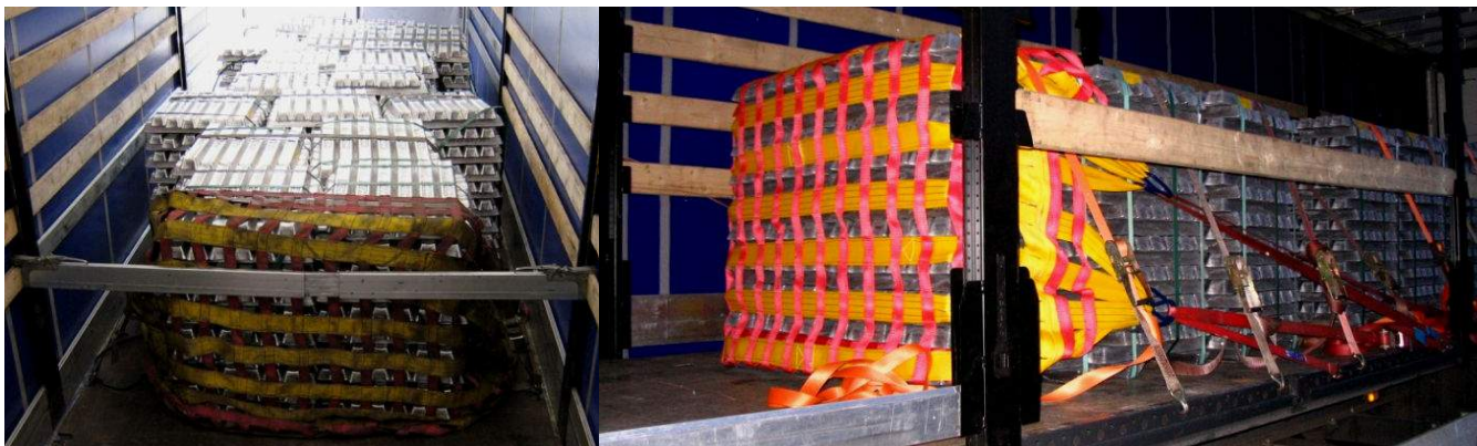
Upevnenie ingotov dopredu sieťou – 4 čelné dvojité viazania do 20 ton
