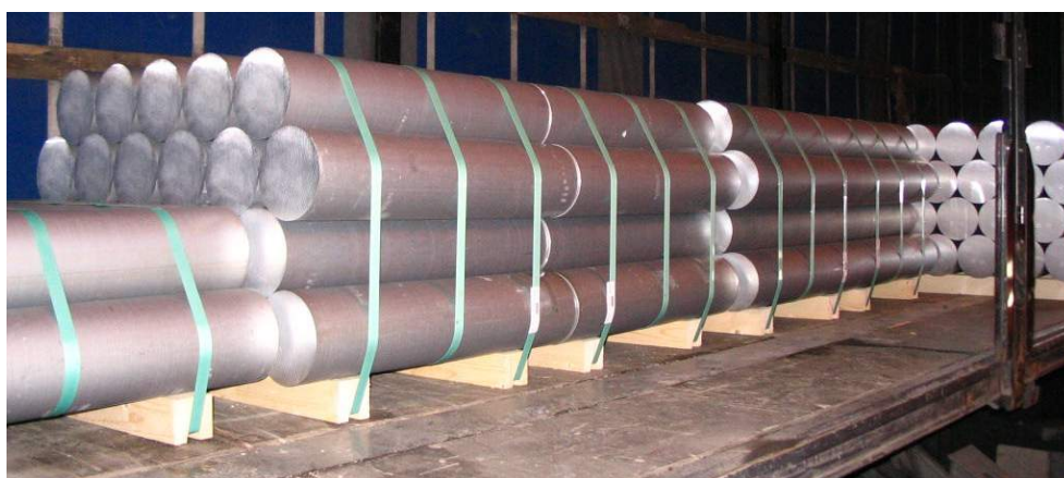
Balenia krátkych čapov kompaktné naložené v návесе a tým upevnené blokovaním
